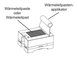
Fig. 11 Vor der Montage auf dem Kühlkörper muss auf der Grundfläche des SSR eine dünne Schicht wärmeleitender Silikonpaste gleichmäßig aufgetragen werden. Alternativ kann ein Wärmeleitpad eingesetzt werden. Das Material der Wärmekontaktfläche beeinflusst die thermische Leistungsfähigkeit. Stellen Sie sicher, dass der Kühlkörper ausreichend dimensioniert ist.
