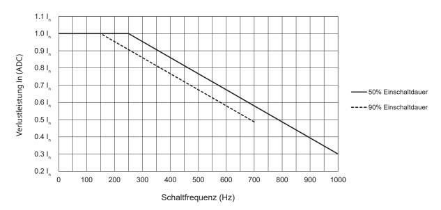
Fig. 6 Strom-Derating und Schaltfrequenz4
