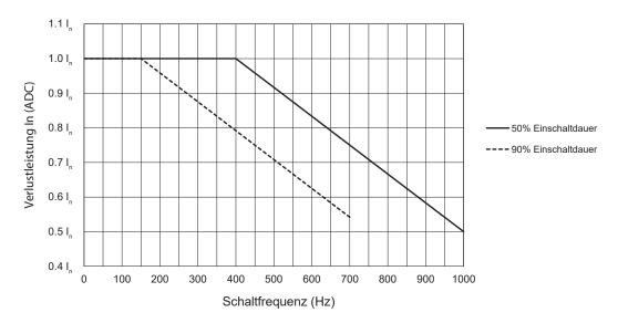
Fig. 5 Strom-Derating und Schaltfrequenz⁴
