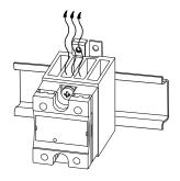
Fig. 13 Kühlkörper mit Kühlrippen in vertikaler Richtung montieren, um ungehinderten Luftstrom durch den Kühlkörper zu gewährleisten.
