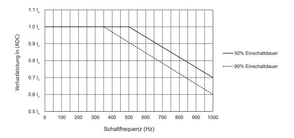
Fig. 4 Strom-Derating und Schaltfrequenz
